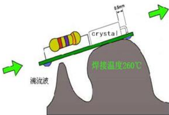
波峰焊接 Wave Solder Profile
